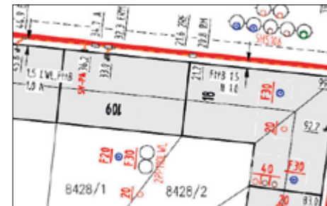
Trasse für LWL-Leerrohre
